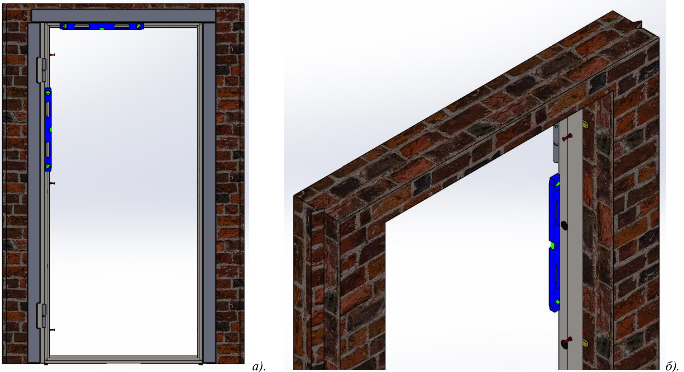
Рисунок: установка коробки по уровню на распорные клинья.
